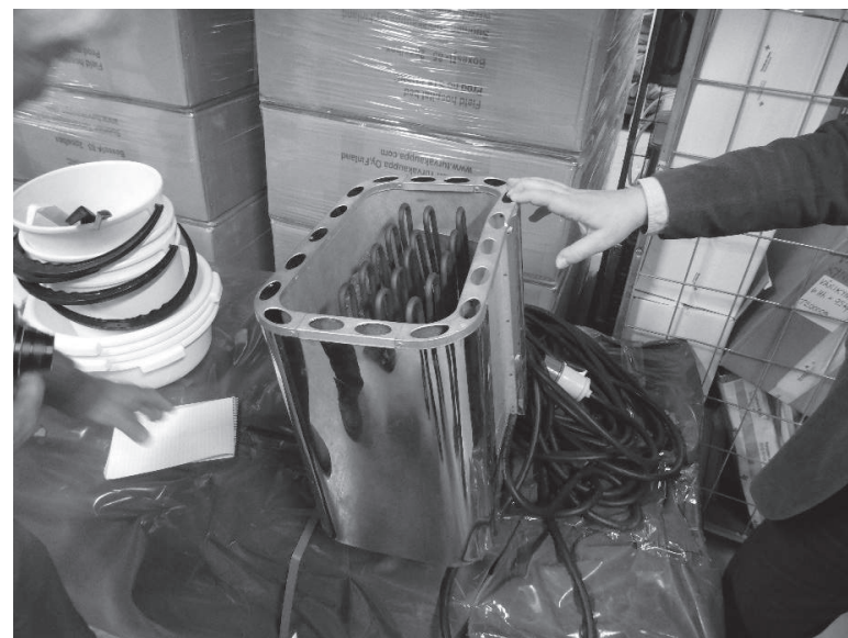
写真4 サウナユニットに使用する電熱ヒーター（7kW）
