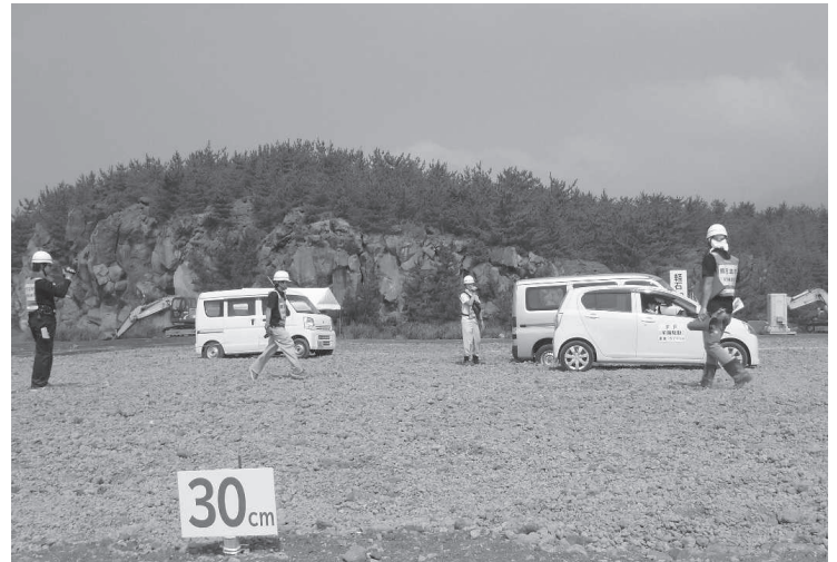
写真3 大量軽石火山灰降下時の車両走行啓開実験の様子（平成30年 鹿児島市）
